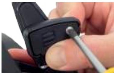
Отвинтите систему быстрого отсоединения крестовой отверткой, удерживая болт, расположенный на противоположной стороне, одним пальцем, чтобы предотвратить его случайное падение.
