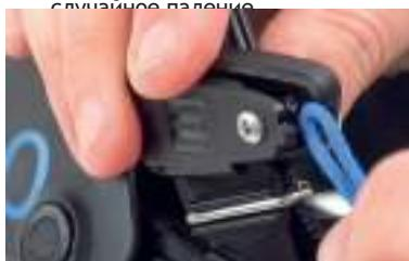
Слегка приоткройте две части крышки вниз, следя за тем, чтобы стык сверху остался на месте. Вставьте петлю и закройте две части крышки так, чтобы винт мог зацепить резьбу болта.
