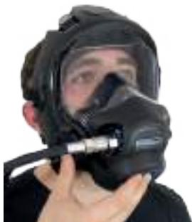
Avec le tuyau BP branché, appuyez sur le bouton de purge du 2ème étage et vérifiez que l'air circule librement. Relâchez le bouton et vérifiez que l'air s'arrête de circuler.
