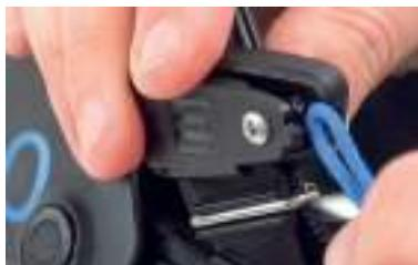
Abra ligeramente las dos partes de la cubierta en la parte inferior, asegurándose de que la junta en la parte superior permanezca en su lugar. Inserte el lazo y cierre las dos partes de la cubierta para que el tornillo pueda atrapar la rosca del perno.
