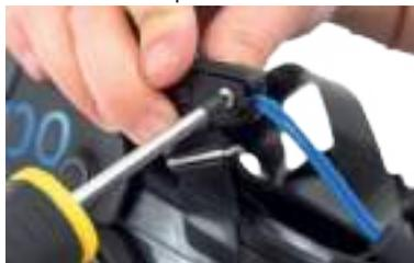
Apriete el tornillo recordando siempre sujetar el perno en el lado opuesto con un dedo. No debe haber espacio entre las dos partes de la cubierta.
