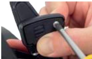
Desenrosque el sistema de liberación rápida con un destornillador Phillips que sujeta el perno colocado en el lado opuesto con un dedo para evitar que se caiga accidentalmente.
