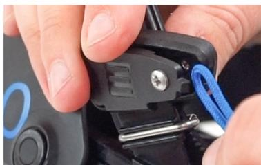
Abre las dos partes de la cubierta en la base, asegurándote de que la unión en la parte superior permanezca en su lugar. Introduce el bucle y cierra las dos partes de la cubierta, para que el tornillo pueda introducirse en la rosca del pasador.
