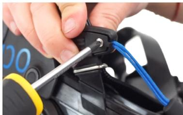
Ajusta el tornillo sin dejar de sujetar el pasador del otro lado con un dedo. No debe quedar ningún tipo de espacio entre las dos partes de la cubierta.
