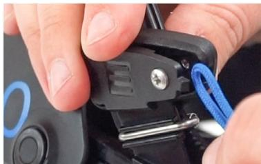
Aprire leggermente i due lati del coperchio nella parte inferiore, assicurandosi che la giunzione nella parte superiore rimanga in posizione. Inserire l'occhiello e chiudere i due lati del coperchio in modo che la vite possa accoppiarsi alla filettatura del bullone.
