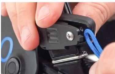
Öffnen Sie die beiden Teile der Abdeckung unten leicht, so dass das Gelenk oben an seinem Platz bleibt. Führen Sie die Schlaufe ein und schließen Sie die beiden Teile der Abdeckung so, dass die Schraube das gegenüberliegende Bolzengewinde erreicht.
